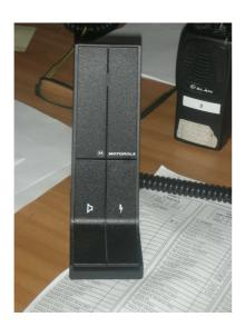
Per trasmettere in fonia una comunicazione si preme il pulsante sul microfono con il simbolo del fulmine (quello con il simbolo dell'altoparlante non è programmato), si aspetta a parlare per almeno un secondo ( per dare il tempo alla radio di trasmettere il "login" di connessione alla rete), poi si parla a voce normale tenendo la bocca a circa 15 centimetri dal microfono, scandendo bene ogni parola che si pronuncia.
