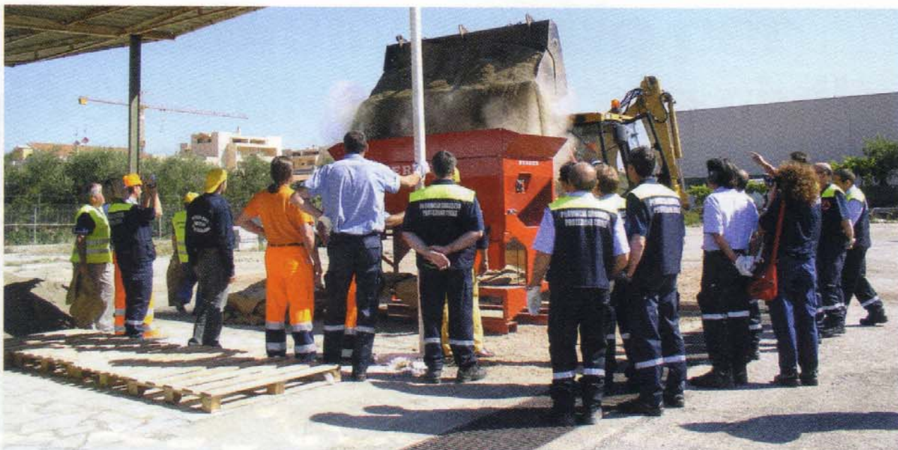
La macchina insacchettatrice capace di confezionare 1.600 sacchetti di sabbia all'ora in dotazione al Servizio di Protezione Civile della Provincia di Grosseto
